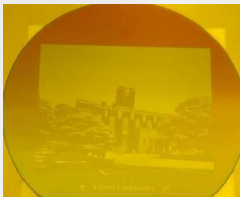
MLA150によるリソグラフィ結果 (京都大学時計台) 6インチウエハーに30分で描画
